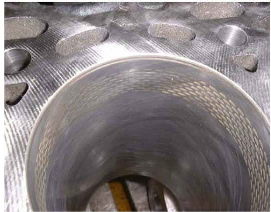
图 6 采用激光造型工艺加工后的缸孔
