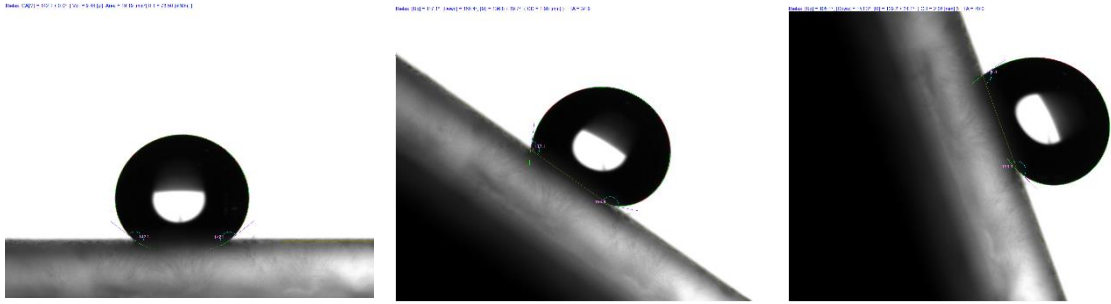
图 3 倾斜台测量动态接触角和滚动角
