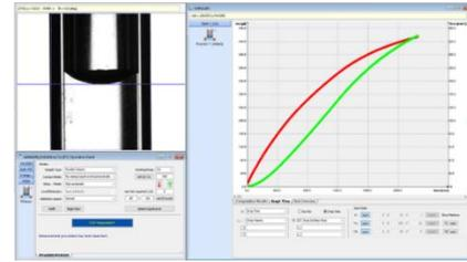
II: 高速视频系统完成粉末或多孔材料对液体吸收过程的连续录像，并自动计算全过程的接触角数值
