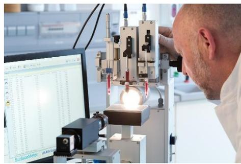
德国 LAUDA Scientific 公司生产的 LSA200 型视频光学接触角张力测量仪是一款测量功能齐备的全能型表面分析仪器。它具有功能多样化的特点，并且能够实现仪器的智能化全自动控制。它不仅可以准确可靠的完成接触角测量，滚动角测量、表面自由能测量和界面张力测量等常用的测量任务，而且在高速动态、多功能测量方面显示了明显的优势
